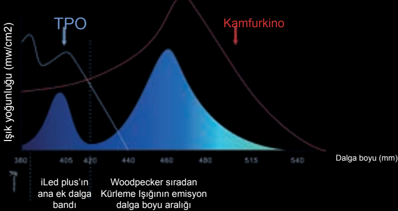
iLed plus Spektral Eğrisi ve Reçine Spektral Soğurma
